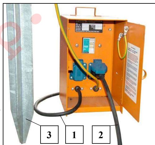
Rys. 17 Mała rozdzielnica budowlana
